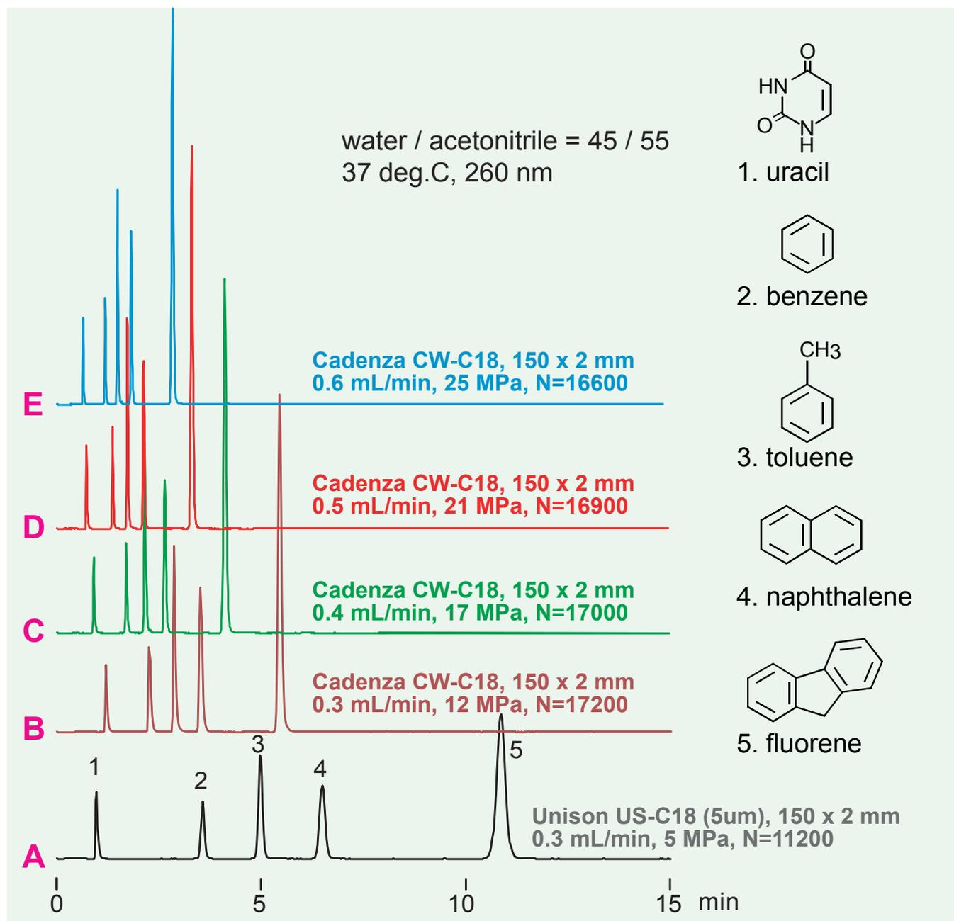
ワイドポアODSカラム Cadenza CW-C18 は、一般的なODSカラムに比べて表面積が約1/3であるため、分析条件を変えずに約1/2程度に高速化することができます。しかも3 μm粒子によるカラム性能の向上が期待できます(クロマトグラム AおよびBの比較)。さらに流量を上げれば、普通のHPLCの圧力範囲で高速分離も可能です(クロマトグラム C-E)。
